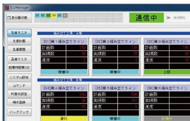
図 2 インテリジェント型生産状況モニター画面の事例
